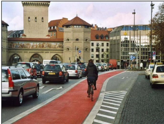
Bild 5: Rot eingefärbter Radfahrstreifen in einer Knotenzufahrt (München)
